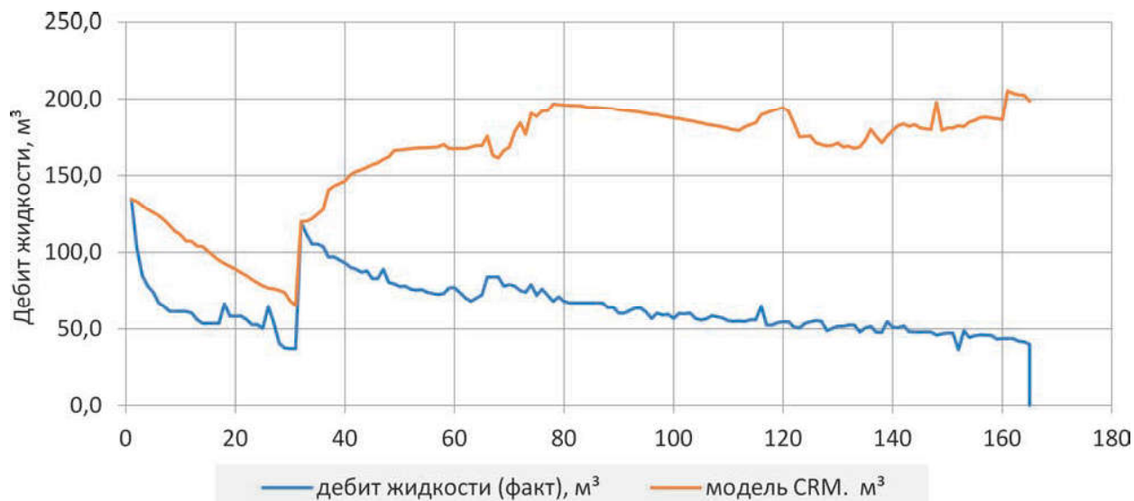
Рис. 8. Настройка модели CRM с учетом забойного давления на дебит жидкости
