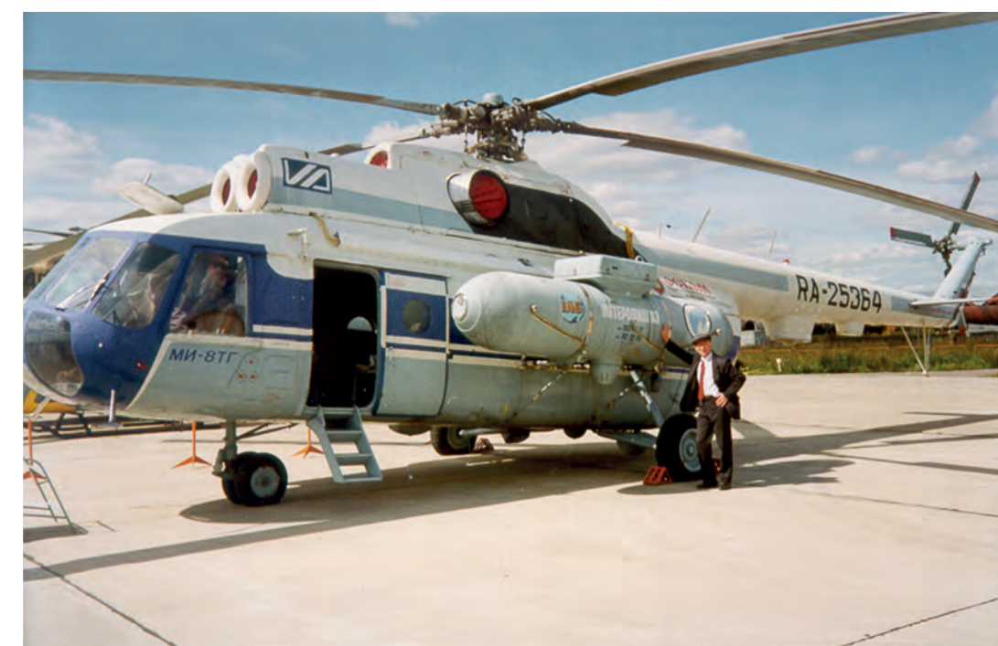
Рис. 4. Газолет – вертолет на газовом топливе
