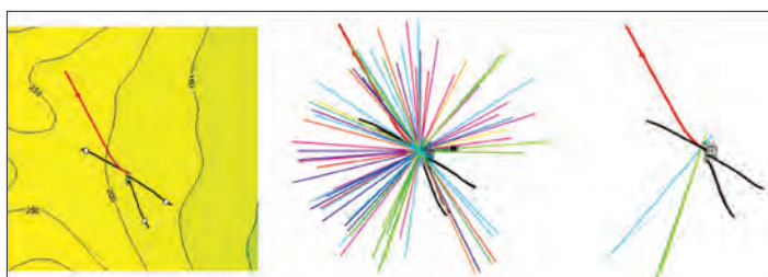
Рисунок 14. Оптимизация выбора траекторий, сгенерированных по новой методике. Скважина № 3 (слева-направо: траектория, утвержденная изначально (красная); все траектории, сгенерированные автоматическим процессом; лучшие три траектории, сгенерированные автоматизированным процессом)
