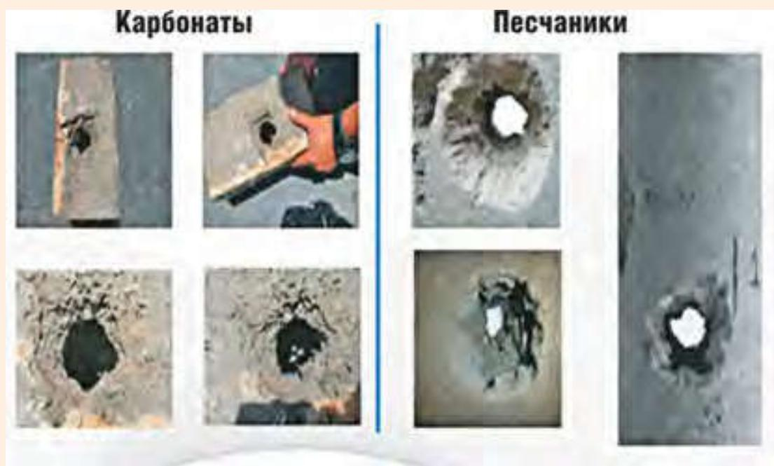
пласта импульс давления, который характеризуется скоростью нарастания, превышающей  $10^3$  МПа/с, и обязательным наличием участка, где давление превышает давление разрыва пласта. Результатом такого динамического, а не квазистатического (как в случае применения технологии ГРП), воздействия на пласт через каналы РВП является:
