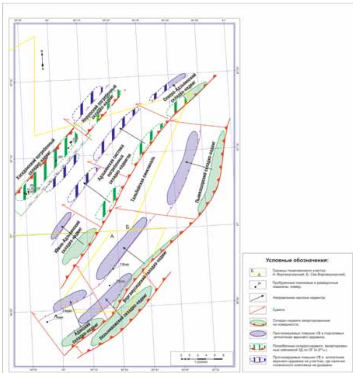
Рис. 7. Фрагмент центральной части гряды Чернышева. Схема прогноза ловушек УВ в подсолевых отложениях верхнего ордовика
